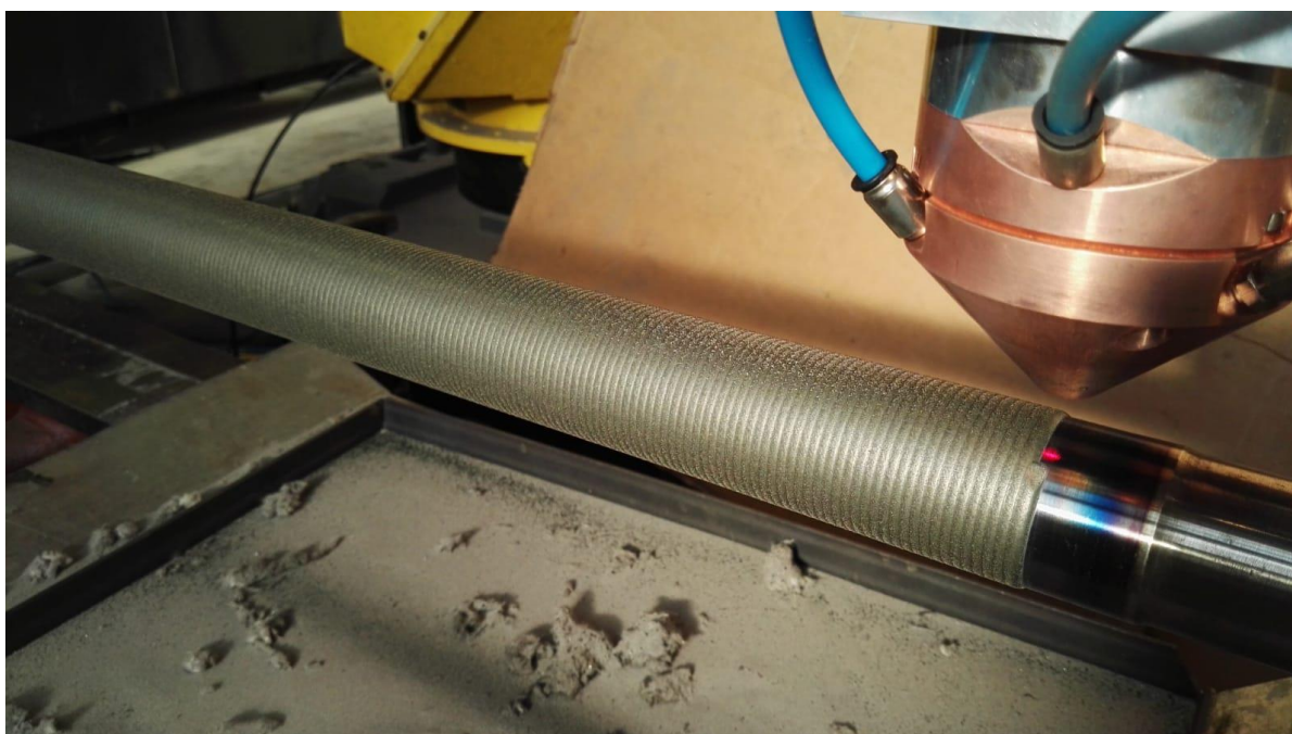
4. ábra: C45 alapanyagú tengely „páncélozása” keményfémme
